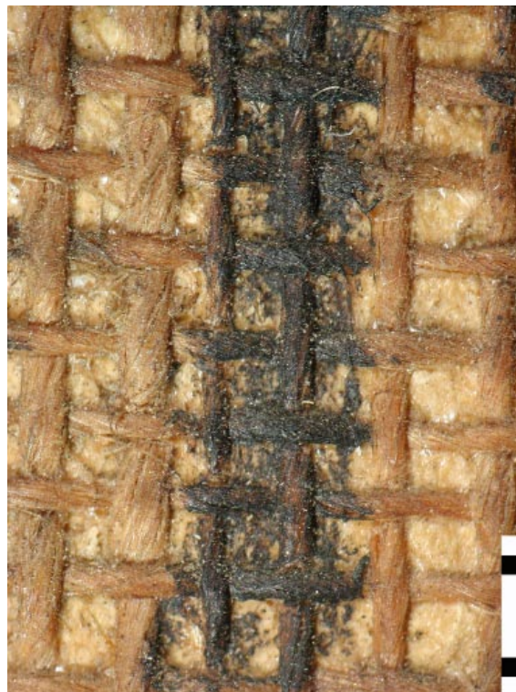
Abb. 10 Offenmaschiges Gewebe mit erkenn- baren „Leimhäutchen“ der Vorleimung in den Fadenzwischenräumen und Stempelfarbe des Händlerstempels, Mikroskopaufnahme (M = 1 mm)
