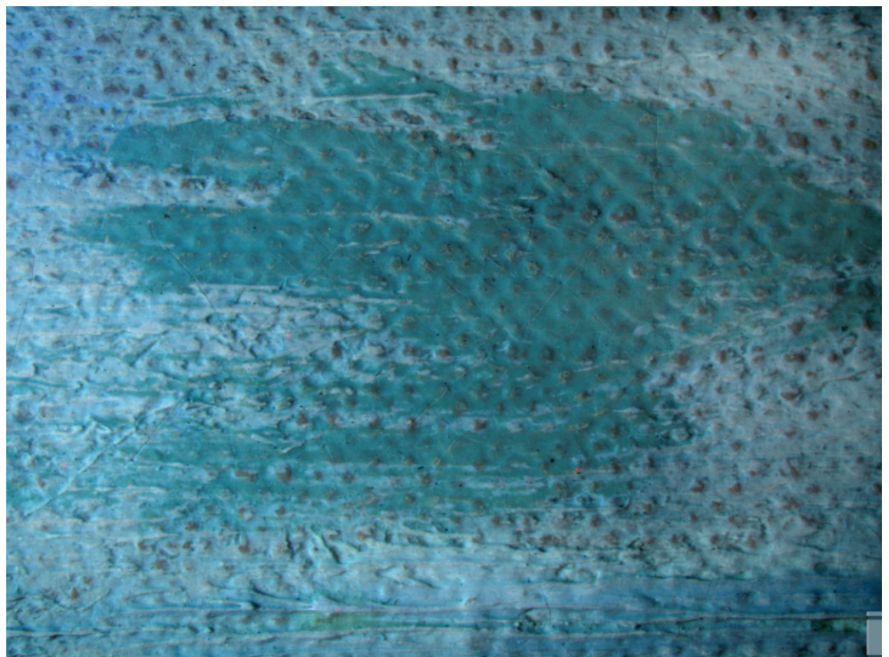
Abb. 16 Mikroskopaufnahme des Details aus Abb. 15 in UV-Anregung, die sich im sichtbaren Licht kaum farblich abzeichnenden Hinzufügungen markie- ren sich grünlich in der UV-Fluoreszenz-Aufnah- me (M = 1 mm)
