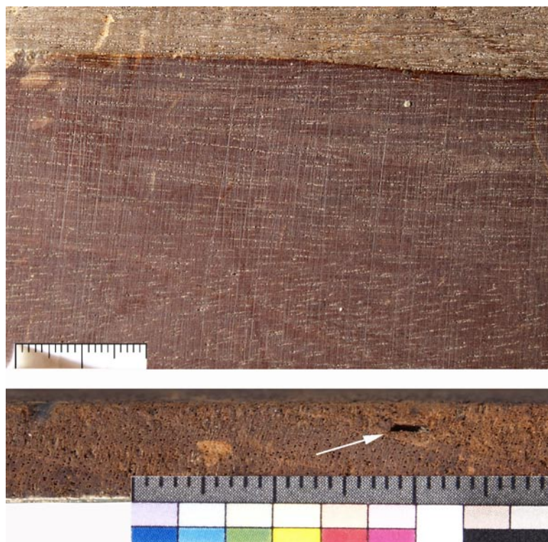
Abb. 6 Details, rückseitige Herstellungsspuren auf dem Holzbildträger, oben im Streiflicht, unten Spur einer Befestigung (Pfeil)
