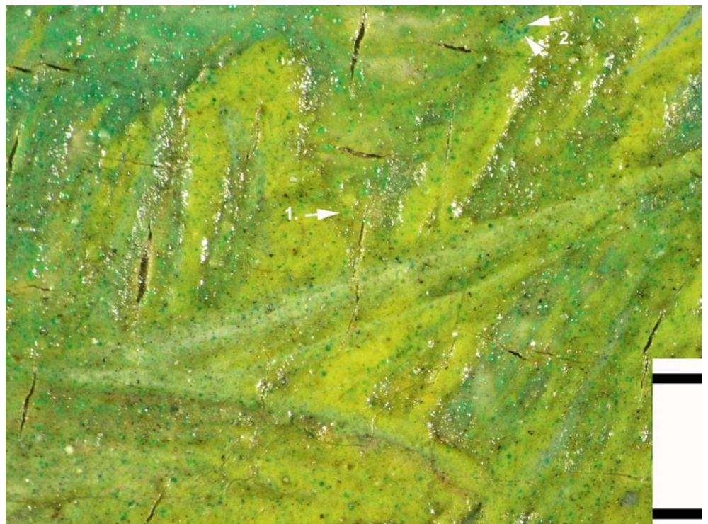
Abb. 10 Grün ausgemischte Farbschicht mit zwei verschiedenen Pigmen- tierungen, laut VIS-Spektrometrie handelt es sich offenbar um ein Kupfergrünpig- ment (1) und Chromoxid- hydratgrün (2), Mikroskopaufnahme (M = 1 mm)
