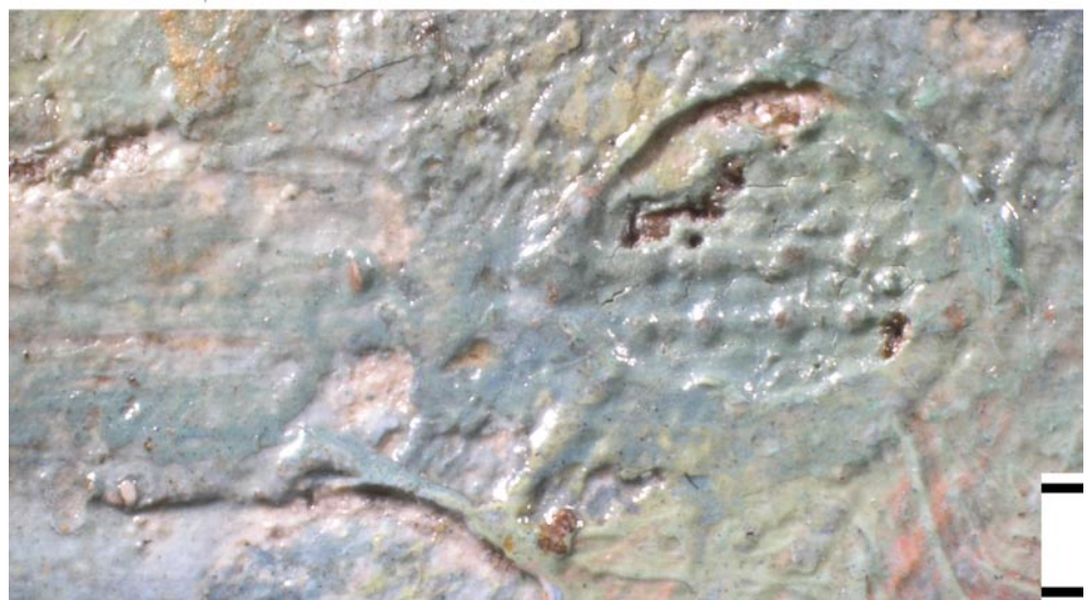
Abb. 12 Detail, linke Bildecke, kreisrunde Abdrücke in der frischen Farbe stammen vermutlich von handelsüblichen Abstandhaltern (siehe oben), Mikroskopaufnahme (M = 1 mm)
