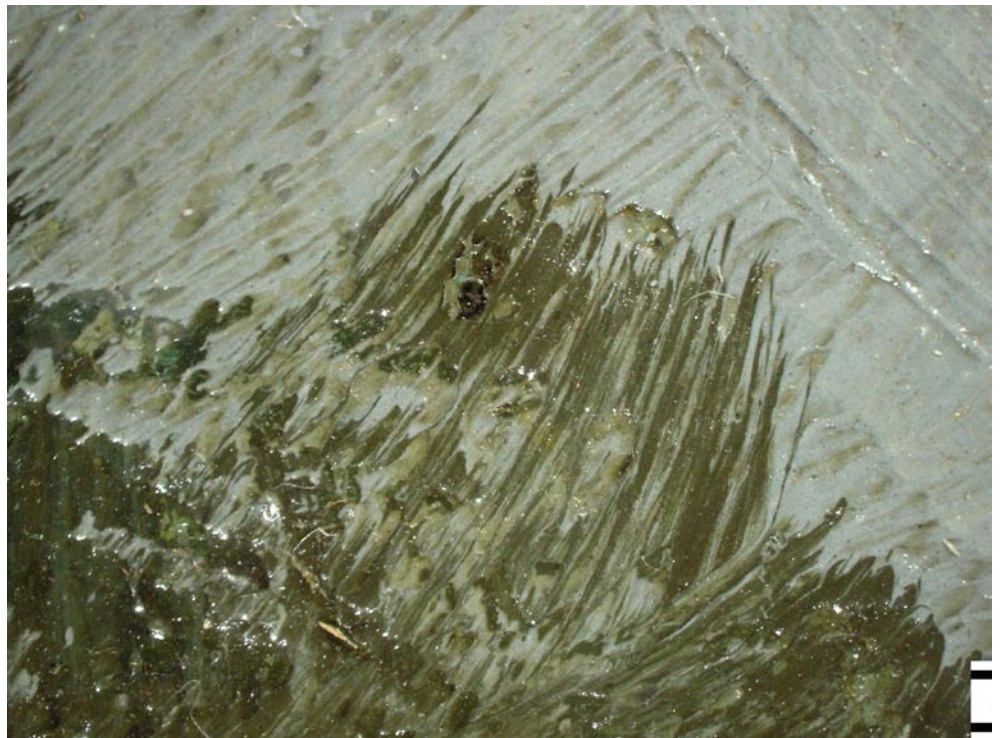
Abb. 10 Farbauftrag nass in nass vermalt, Mikroskopaufnahme (M = 1 mm)
