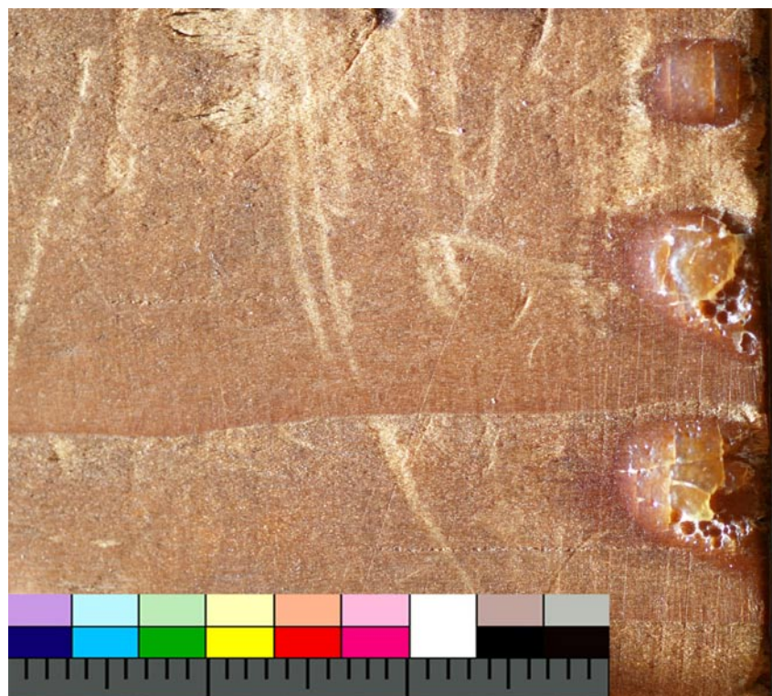
Abb. 12 Detail, Firnistropfen auf der Rückseite
