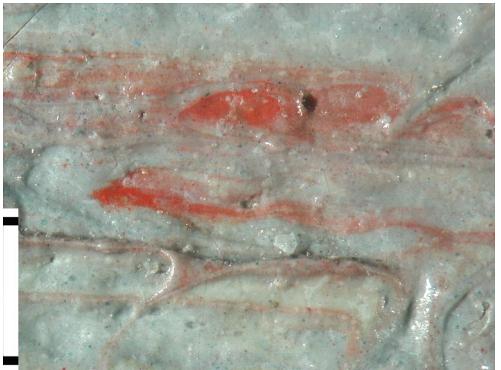
Abb. 12 Farbausmischung mit hellroter Farbschliere, vermutlich handelt es sich um Zinnober(?), Mikroskopaufnahme (M = 1 mm)
