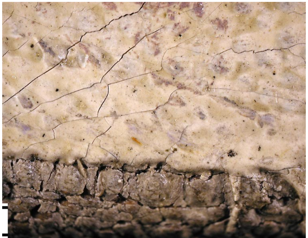
Abb. 6 Zweischichtiger Grundierungsauftrag, Pinselduktus in oberer, cremefarbener Schicht sichtbar, Mikroskopaufnahme (M = 1 mm)
