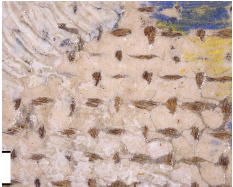
Abb. 11 Beriebene Farb- und Grundierungsoberfläche, die Gewebeshöhen sind sichtbar, Mikroskop- aufnahme (M = 1 mm)
