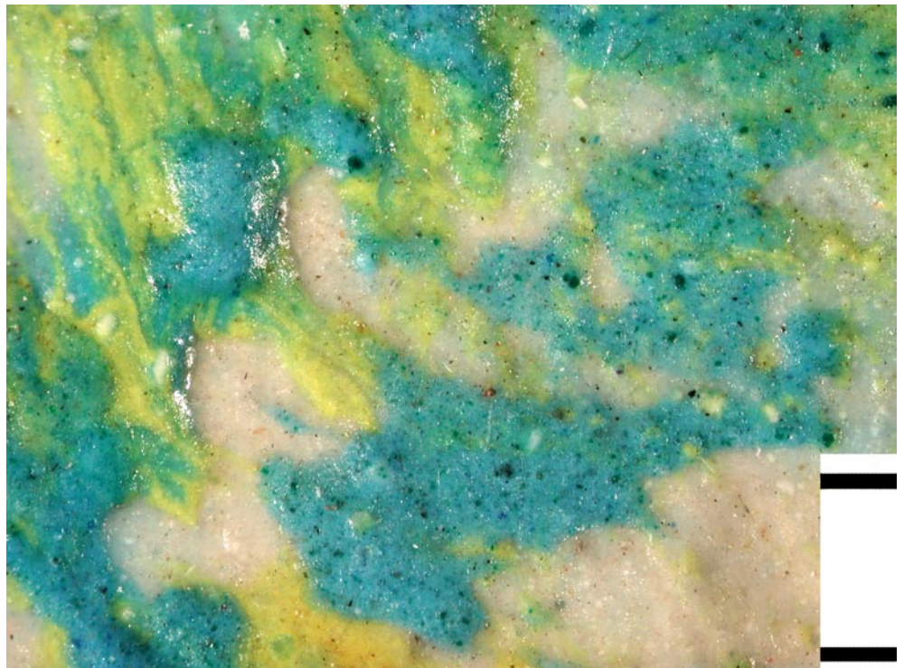
Abb. 12 Farbschichten mit wachs- artigem Charakter und deutlicher Pigmentierung, Mikroskopaufnahme (M = 1 mm)
